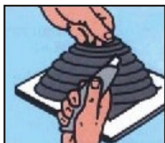
1. Dektite® an Rohr anpassen
