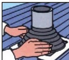
3. Dektite® formgenau an Profilblech anpassen
