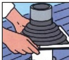
2. Dektite® an Profilblech anpassen und markieren
